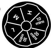
Empfindlichkeitsschalter Sprühzeit anpassen
